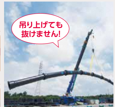
耐震管の吊り上げ実験の様子 (画像提供:日本ダクタイル鉄管協会)
