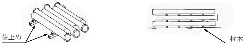
4. 取扱いは、台棒、角材等を敷いて直接地面に接することがないようにし、吊り上げる場合は台付けを確実に取ること。
