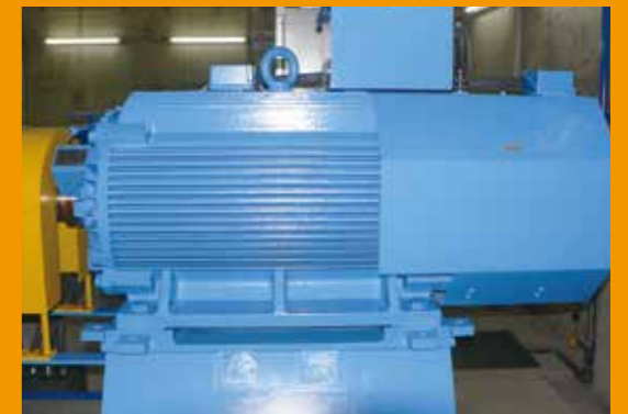
水車から送られた回転力を電気に変えます。
